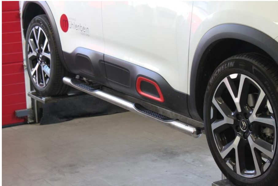
Schwellerrohre / Side bars C5/2, Ausf. A
